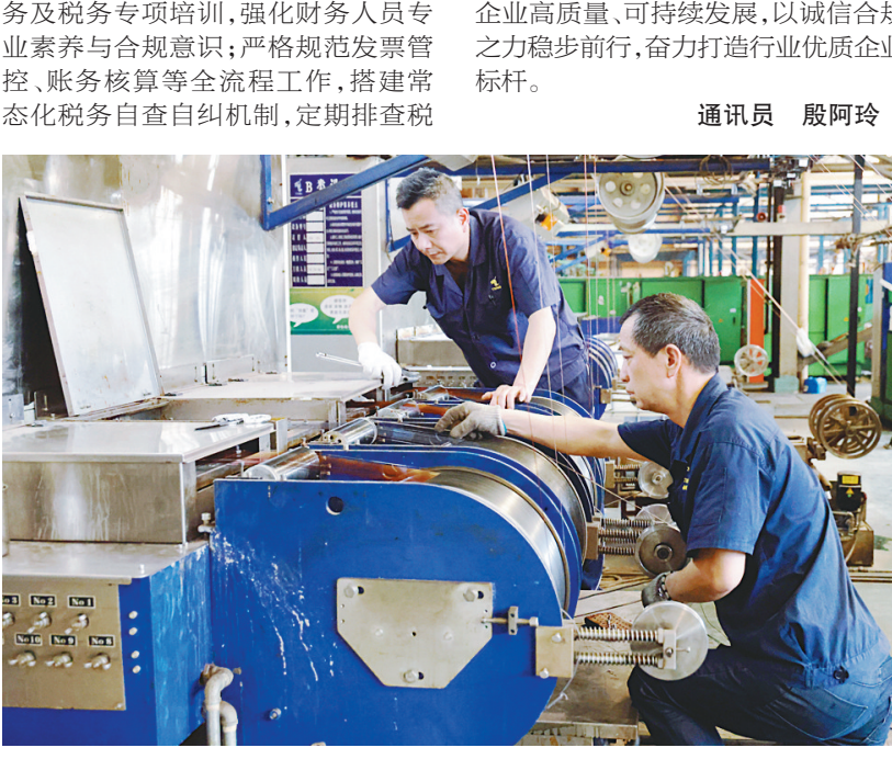
日前,铜冠电公司漆包线分厂员工正在对设备开展维修保养作业。该分厂今年以来围绕降本增效工作,在加强设备维护保养的基础上,加大修旧利废力度,通过对损坏的设备零部件实施精准修复,既有效降低了采购费用,又保障了设备稳定运行和生产的连续性。本报记者 王红平 通讯员 岳莹 摄
