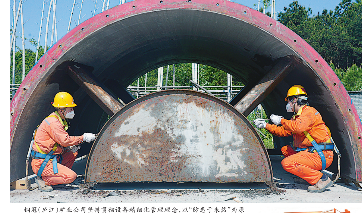
铜冠(庐江)矿业公司坚持贯彻设备精细化管理理念,以“防患于未然”为原则,常态化开展大型设备除锈防腐、维护保养工作,从源头把控设备运行状态。图为近日两名员工对大型设备开展维保工作。通讯员 黄从斌 摄
