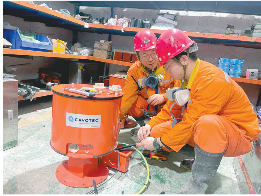
铜冠(庐江)矿业公司采矿工区一直坚持实施设备预防性维护,通过定期检测、分析设备运行状态,及时发现并处理潜在故障,降低设备故障率。图为近日该工区两名维修人员对电动铲运机循环箱进行检查维保。
