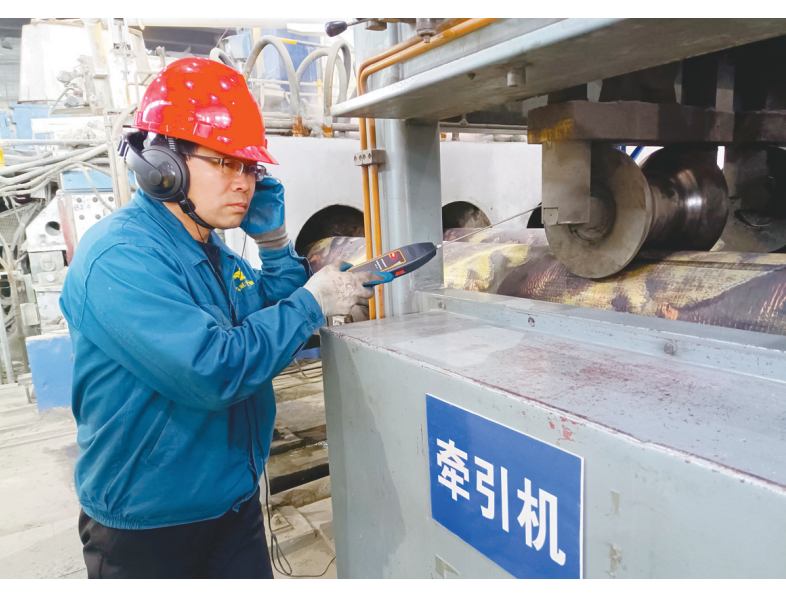
3月9日,铜冠黄铜公司点检工程师正在通过机械故障听诊器对设备进行点检。该公司着力加强设备的点检预修管理,从而提高设备运行稳定性和生产效率,降低生产不良率,保障生产运营平稳运行。本报记者 王红平 通讯员 陈旭 摄
