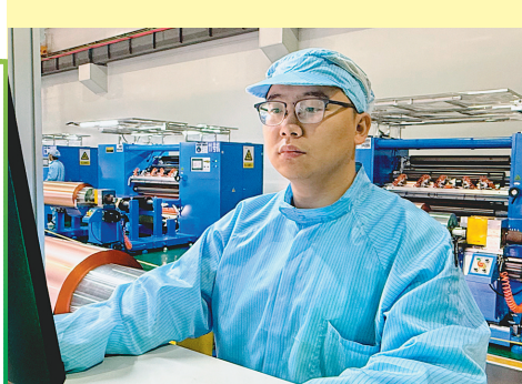
◀ 图为杨帆正使用分切机在线监测系统观看铜箔表面外观情况。
