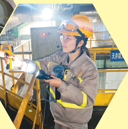
▼ 图为王宇馨在现场测量奥炉炉体温度。
