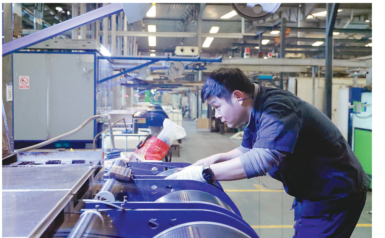
2月4日,铜冠电工公司漆包线分厂员工正在生产铝漆包线。该公司通过提升漆包机生产速度、优化生产工艺、改变绝缘漆涂层结构、规范附属设备设施巡检等措施,使漆包线生产质量得到进一步提升,其中铝漆包线成品率达97.80%,创历史新高。 本报记者 王红平 通讯员 岳莹 摄
