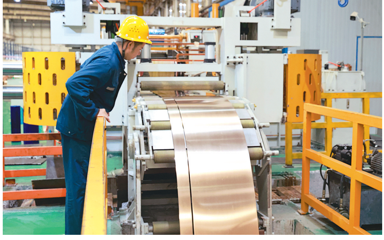
日前,金威铜业分公司员工正在生产作业。该分公司通过不断创新,狠抓新产品研发,取得了积极成果,陆续开发出C1970以及C18150、C18140系列产品。其中,C1970导电率达82%,超过国内合金头部企业;C18系列产品抗拉强度达600兆帕,导电率高于85%,达到国内顶尖水平。
