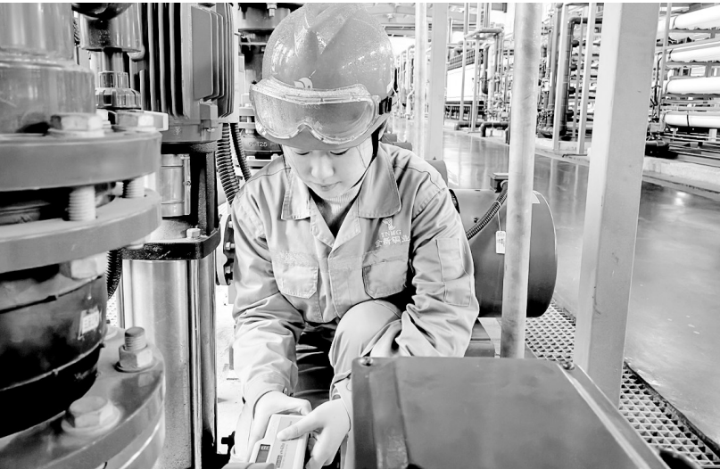
图为赵喆在现场测量设备振动数值。
