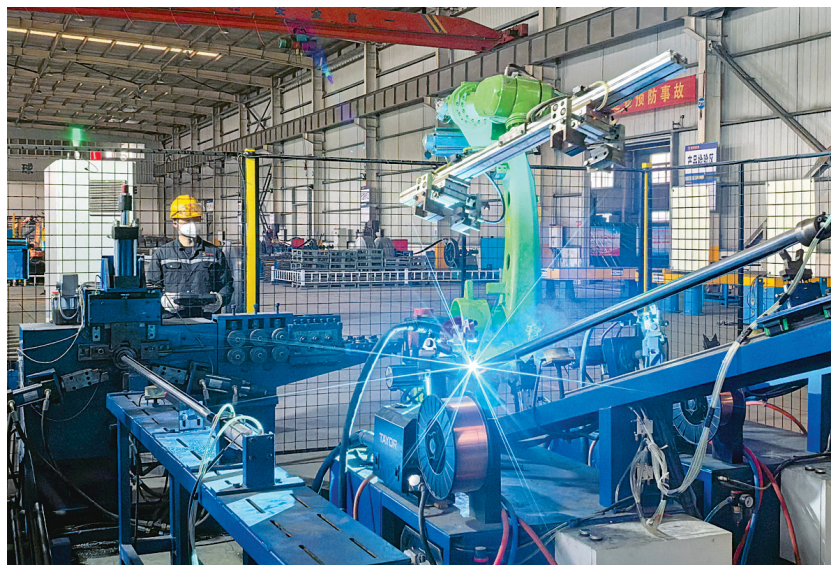
铜冠投资装备公司不断加大新设备升级力度,通过构建自动化生产作业线,有效缩短生产周期,降低人工成本,推动产品生产效率持续提升。图为近日该公司锚杆锚网车间员工操作锚杆焊接新设备的场景。 通讯员 王敬涛 摄
