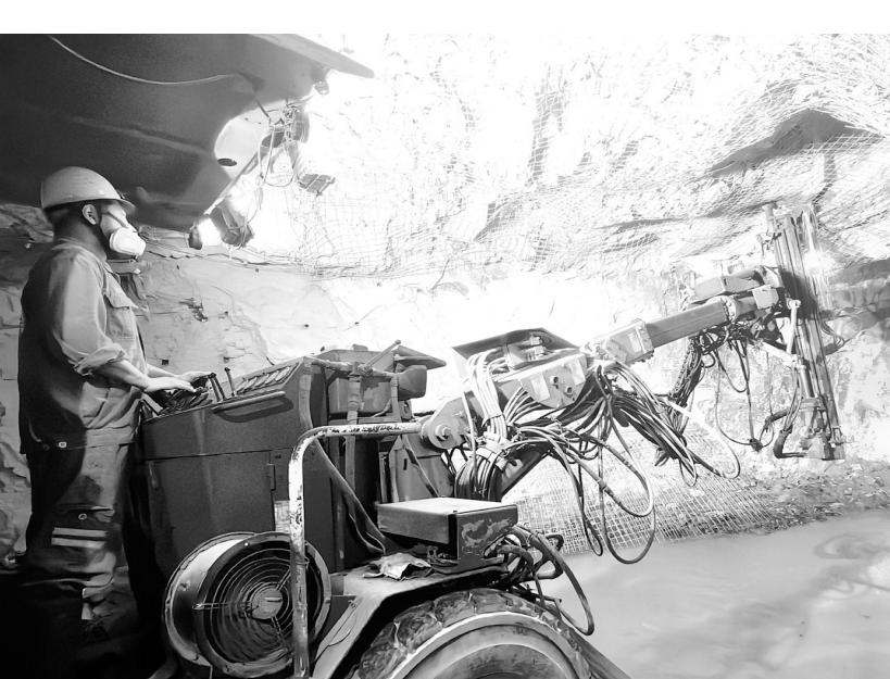
新年第一天，冬瓜山铜矿掘进二区职工正在进行掘进作业面铺网支护作业(如图)。元旦假日期间，该区一线员工坚守岗位，奋勇拼搏，为矿山安全生产工作迈出坚实的“第一步”。新年首日，该区完成掘进量187.5立方，矸石运输出450吨。
