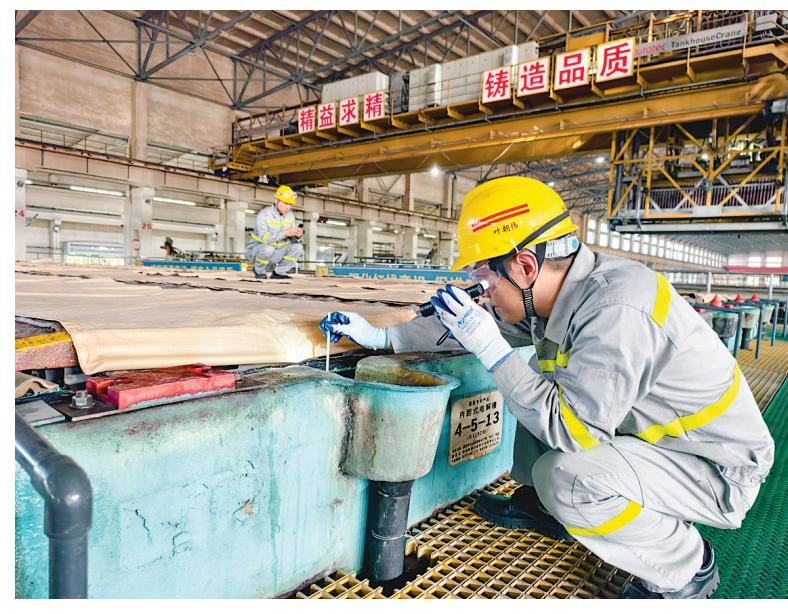
日前,金冠铜业分公司双闪电电解车间员工在检测电解铜短路和电解液比重、温度、流量等进行精准把控,有效保证电解铜生产质量。 通讯员 谢君 摄
