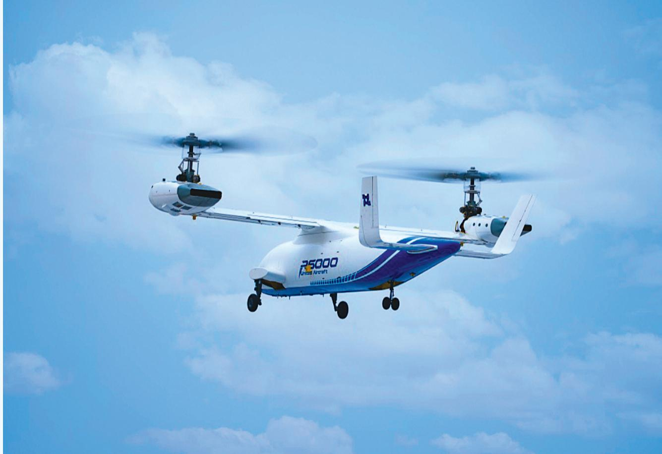
2025年12月28日，由联合飞机集团自主研制的6吨级倾转旋翼无人飞行器“铜影R6000”通过倾转旋翼设计技术，实现旋翼姿态在垂直起降与高速平飞模式之间的无缝、安全平稳切换，融合了传统直升机的垂直起降与精准悬停能力，以及固定翼飞机的长航程、大载重、高速巡航优势。其巡航速度达到550公里/小时，最大航程长达4000公里，实用升限7620米，最大商载2000公斤，性能指标全面超越传统旋翼机平台。
