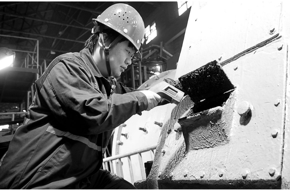
图为王青山在测量齿轮组表面油温、检查球磨机运行状态。
