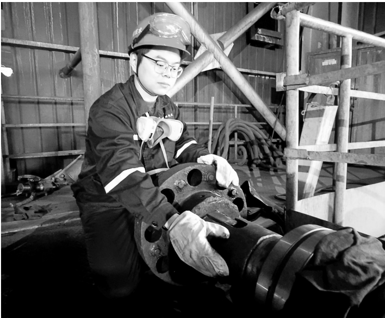
图为余顺仕在金冠铜业双闪厂区冶炼车间对螺旋转子进行润滑。
