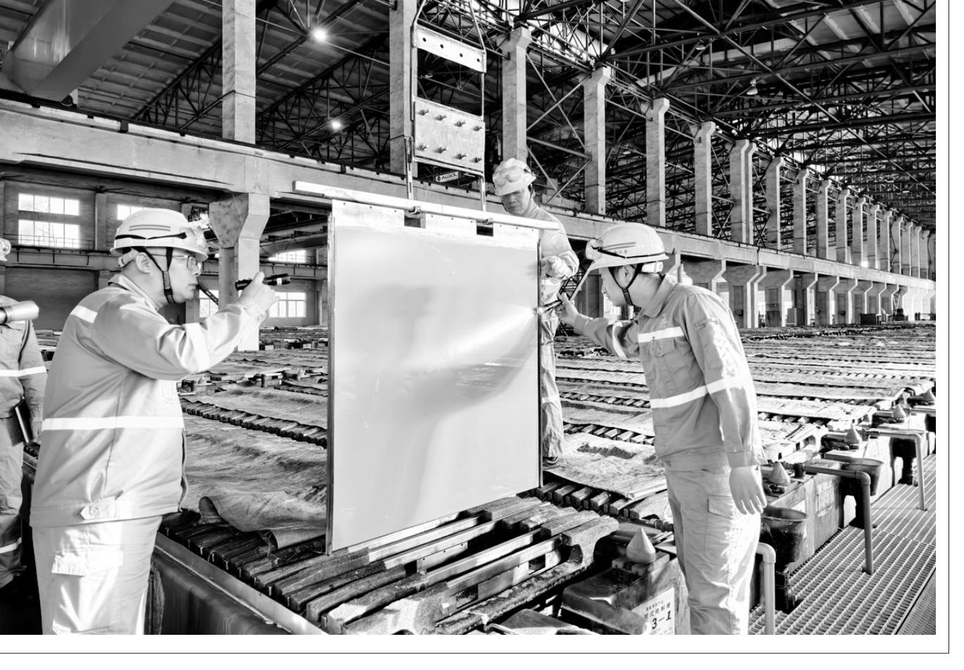
近期,金冠铜业分公司组织生产骨干坚持每天到电解槽面察看,确保阴极铜质量稳定。该分公司着力加强前后工序协同,严控入槽铜阳极板物料外观管理;加大电解液过滤系统维护,保障电解液过滤效果;加大对槽电解铜质量初检,确保打包入库阴极铜质量品质。
