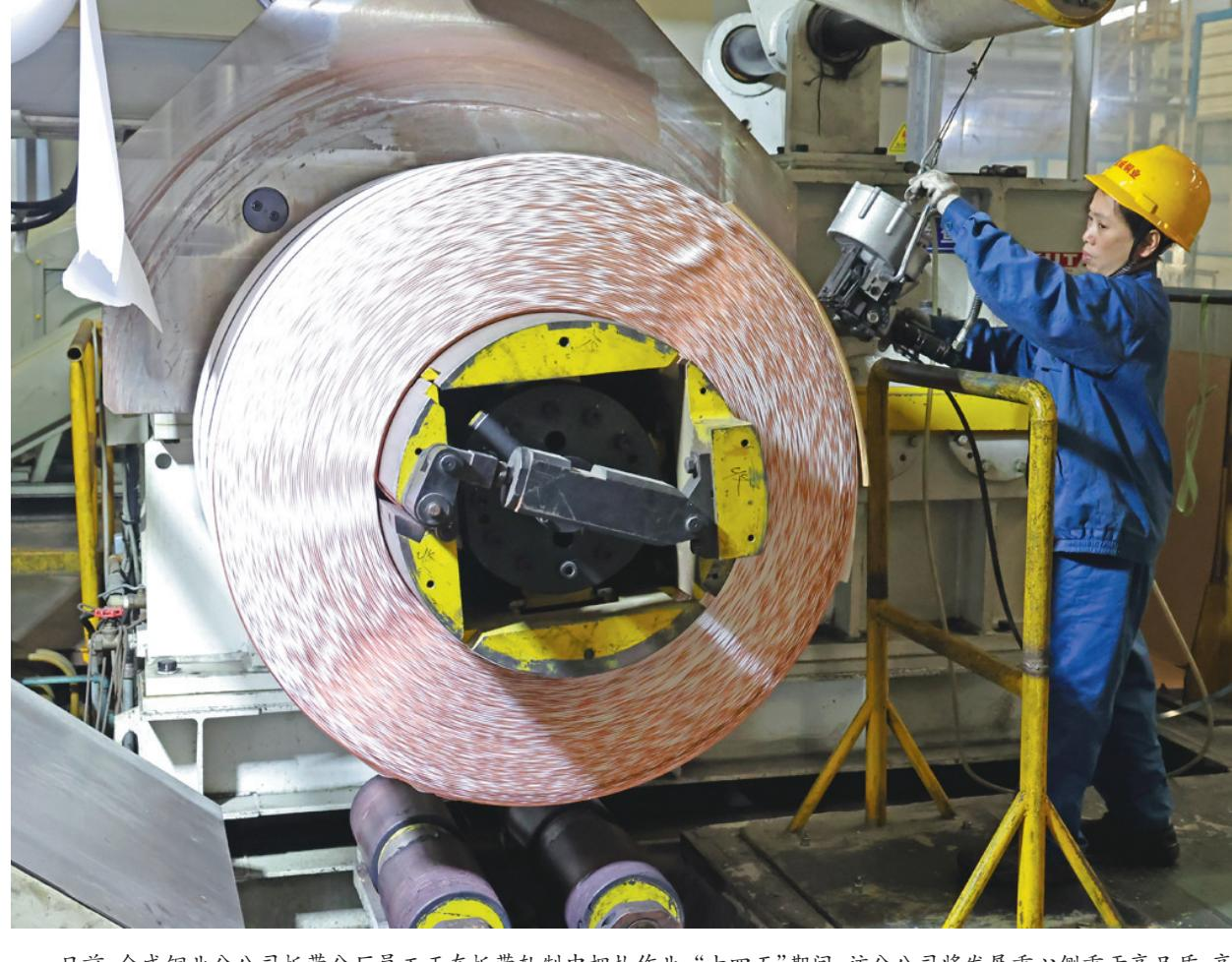
日前，金威铜业分公司板带分厂员工正在板带轧制中捆扎作业。“十四五”期间，该分公司将发展重心侧重于高品质、高附加值产品，通过优化熔铸、轧制、退火及清洗等工艺，通过管理、点检、维修三级联动机制，确保产品的高品质，实现效益的最大化。
