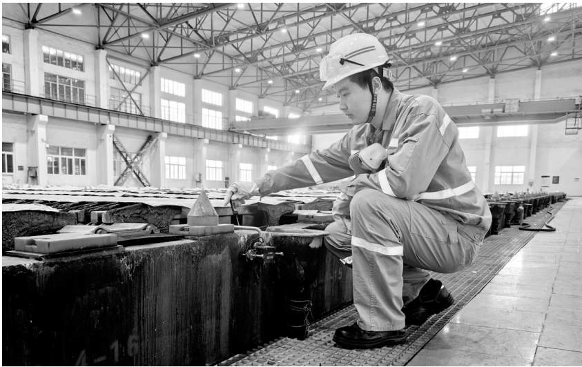
图为邵浩东正在电解槽面检测电解液温度。
