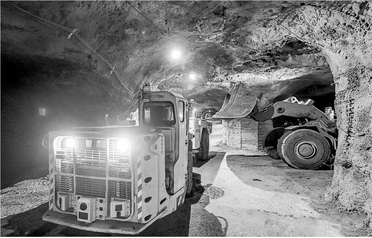
图为无人铲运机和无人矿卡在铜陵有色冬瓜山铜矿井下负800米中段试验区域41线作业区进行铲运协同作业。
