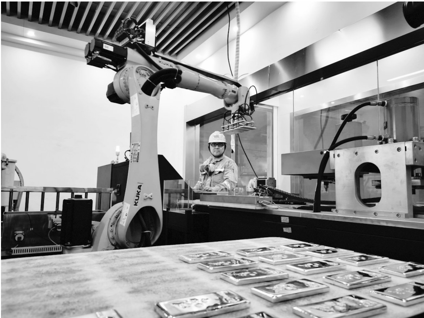
图为金冠铜业分公司稀贵车间金自动浇铸生产现场。
