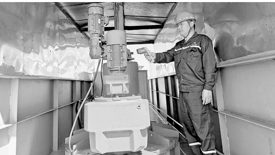
图为刘坚在现场测量浓密机主驱电机温度。
