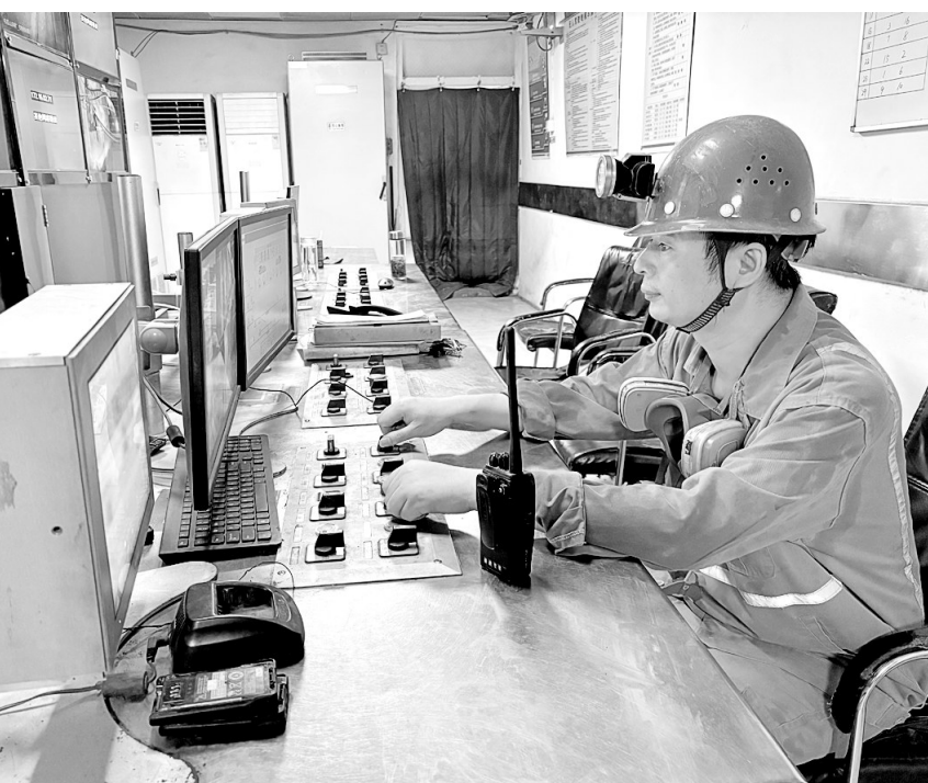
图为郜卫民在负1000米中段使用无人驾驶运输编组进行远程放矿。
