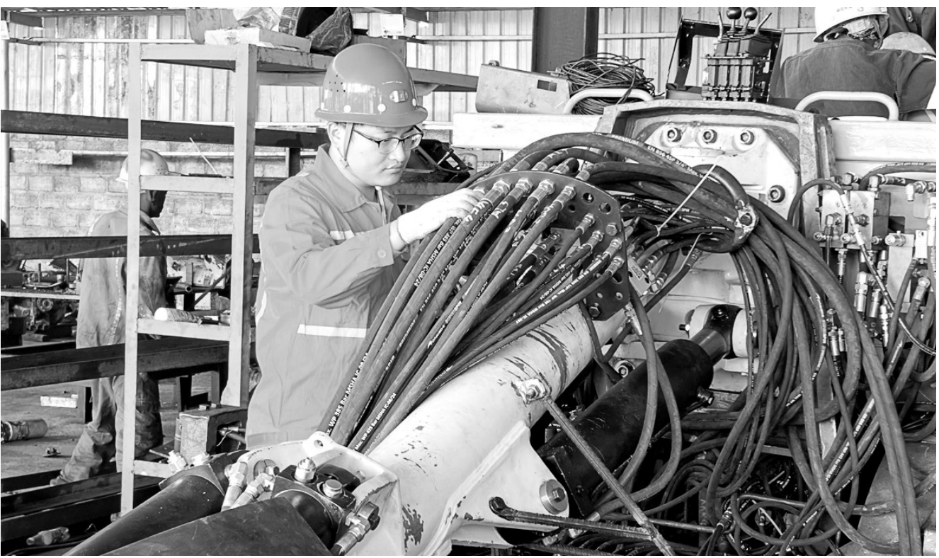
图为何佳伟在赞比亚谦比希项目现场进行岩台车液压管路点检。
