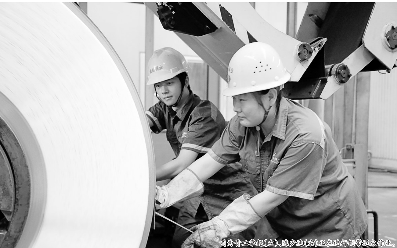
图为青工章超(左)、陈少迪(右)正在进行铜带退火作业。
