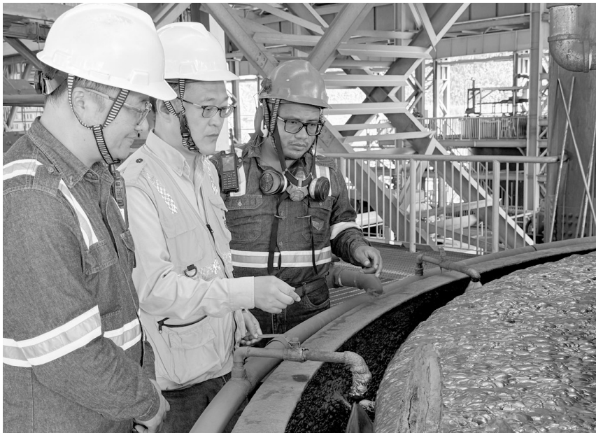
图为代献仁(中)在选矿生产现场对中厄技术员讲解浮选柱操作要点。
