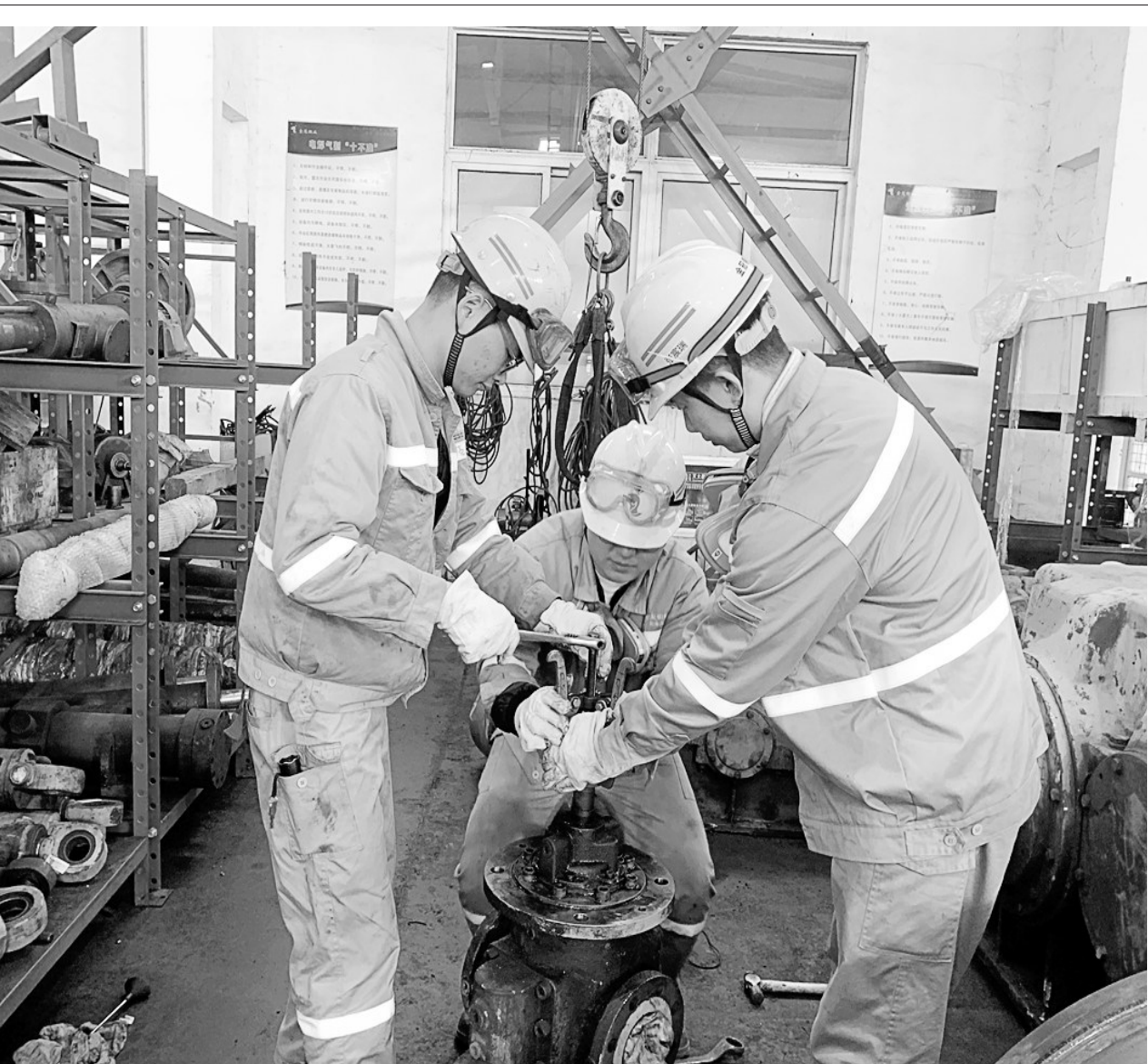
日前,金冠铜业分公司保全车间通过“修旧利废”活动,成功修复进口冰铜磨主润滑泵设备,实现降本增效的同时,也为技能人才培养提供了实践平台。 通讯员 纪永杰 杨年 摄
