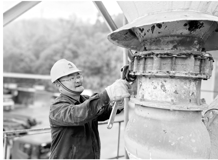
图为张洪一正为粉料螺旋上料系统维保。
