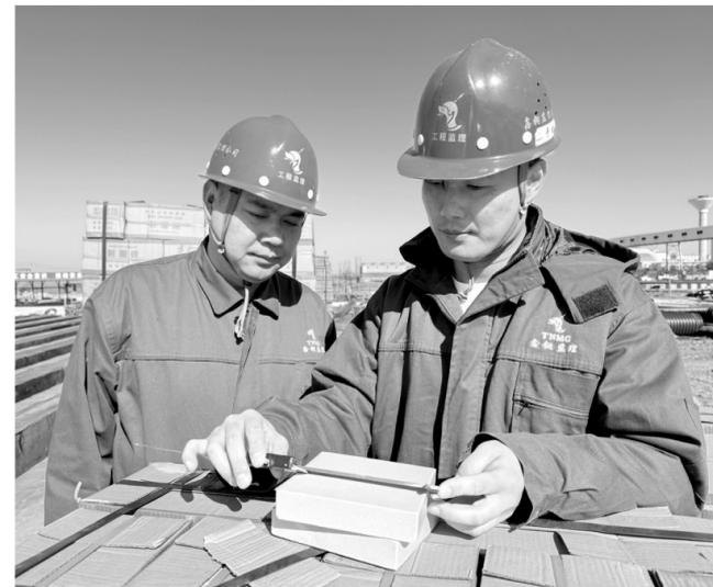
近日,鑫铜监理公司项目部监理人员进一步加强责任意识,对施工单位严格要求,确保项目各项工作安全平稳运行。图为金威铜业分公司项目部监理人员使用游标卡尺对进场的防腐材料耐酸瓷板进行尺寸复核。
