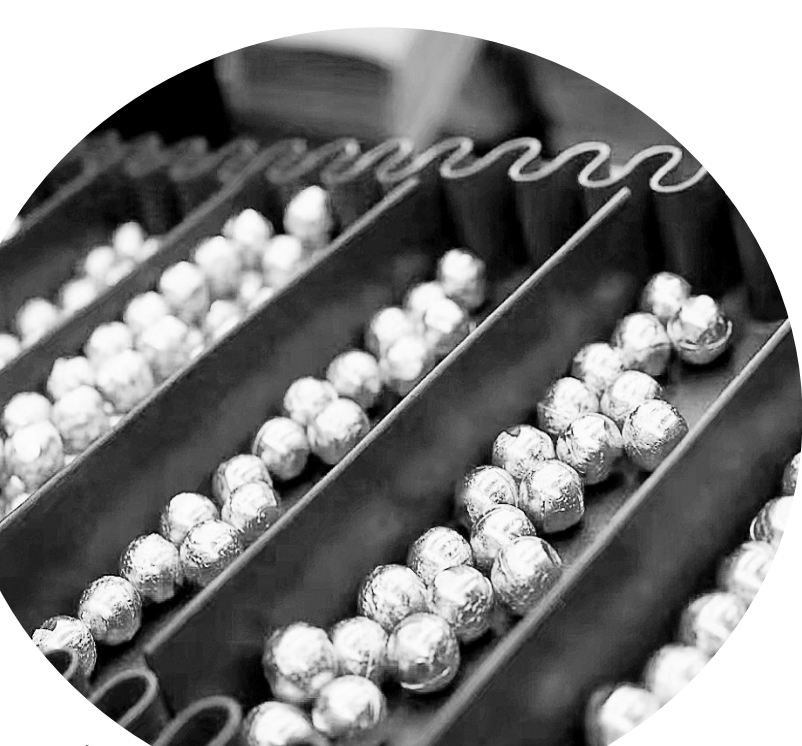
图为超声波清洗后的磷铜球。
