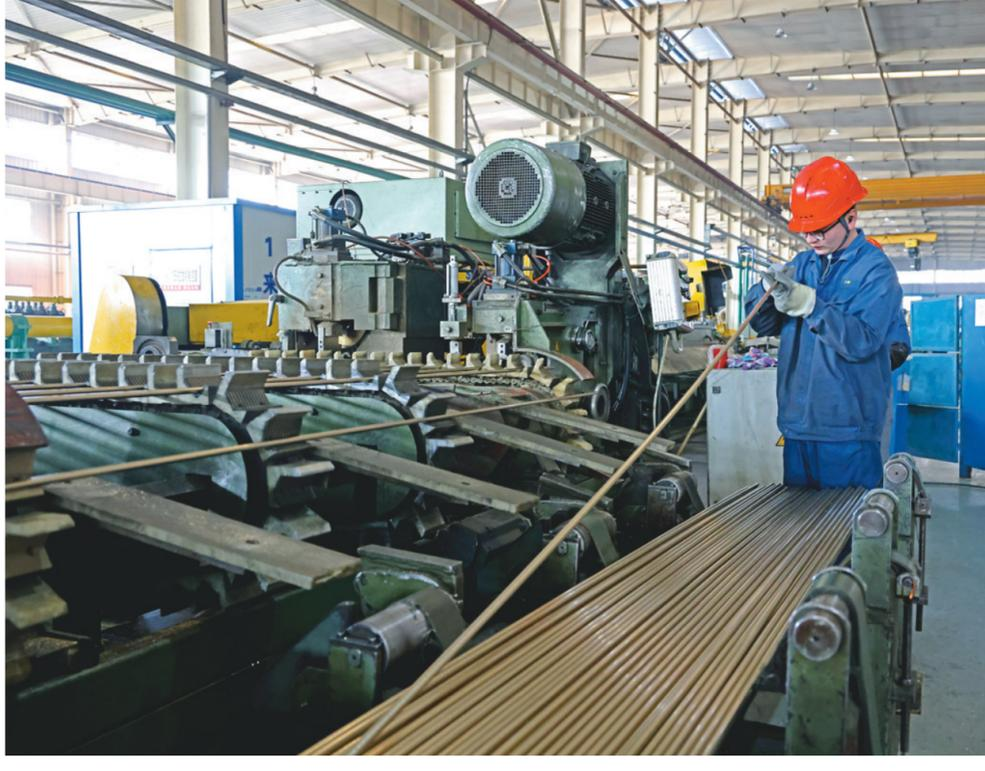
12月20日,铜冠黄铜公司员工正在拉拔生产。铜冠黄铜公司今年围绕突出质量效益主题,切实把产品质量放到更加突出的位置来抓,并通过持续改进生产工艺、提高操作水平、加强质量管理等措施,降低了不合格品率,综合成品率得以稳步提升,目前已突破了70%,创造了铜冠黄铜公司该项指标历史最好水平。
