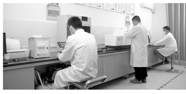
为研发适配不同矿山尾砂的胶凝材料,铜冠建安环保建材公司针对尾砂开展粒径组成分析,同时对胶凝材料相关参数进行检测。图为技术人员开展胶凝材料粉体测试,进行尾砂粒径分析。
