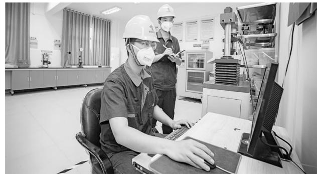
针对新开发矿山充填强度需求,铜冠建安环保建材公司对研发试验块进行抗压强度测定以及数据分析。图为该公司技术研发部技术人员在开展试验块抗压强度试验。
