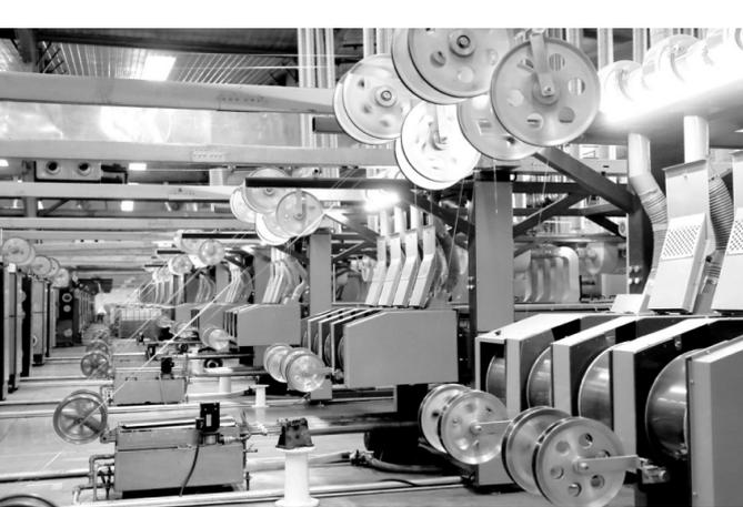
图为铜冠电工公司漆包线分厂西玛梅达高速漆包机设备。
