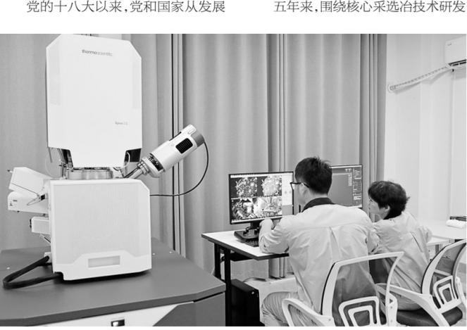
图为铜陵有色技术中心5-Apreo 2S HiVac场发射扫描电镜设备。
