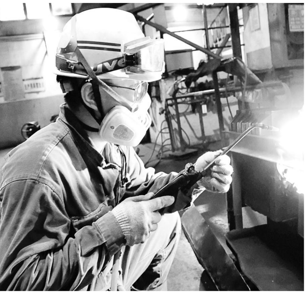
金陵铜业公司稀贵课精炼工序浇铸现场,岗位员工正在对浇铸模具进行烘模预热(如图),为当天的黄金浇铸做前期准备。尽管火焰烤得操作者汗流浹背,但丝毫不影响职工的生产热情,他们坚守在作业现场,抓住生产的有利时机,为完成下半年黄金生产任务快马加鞭。
