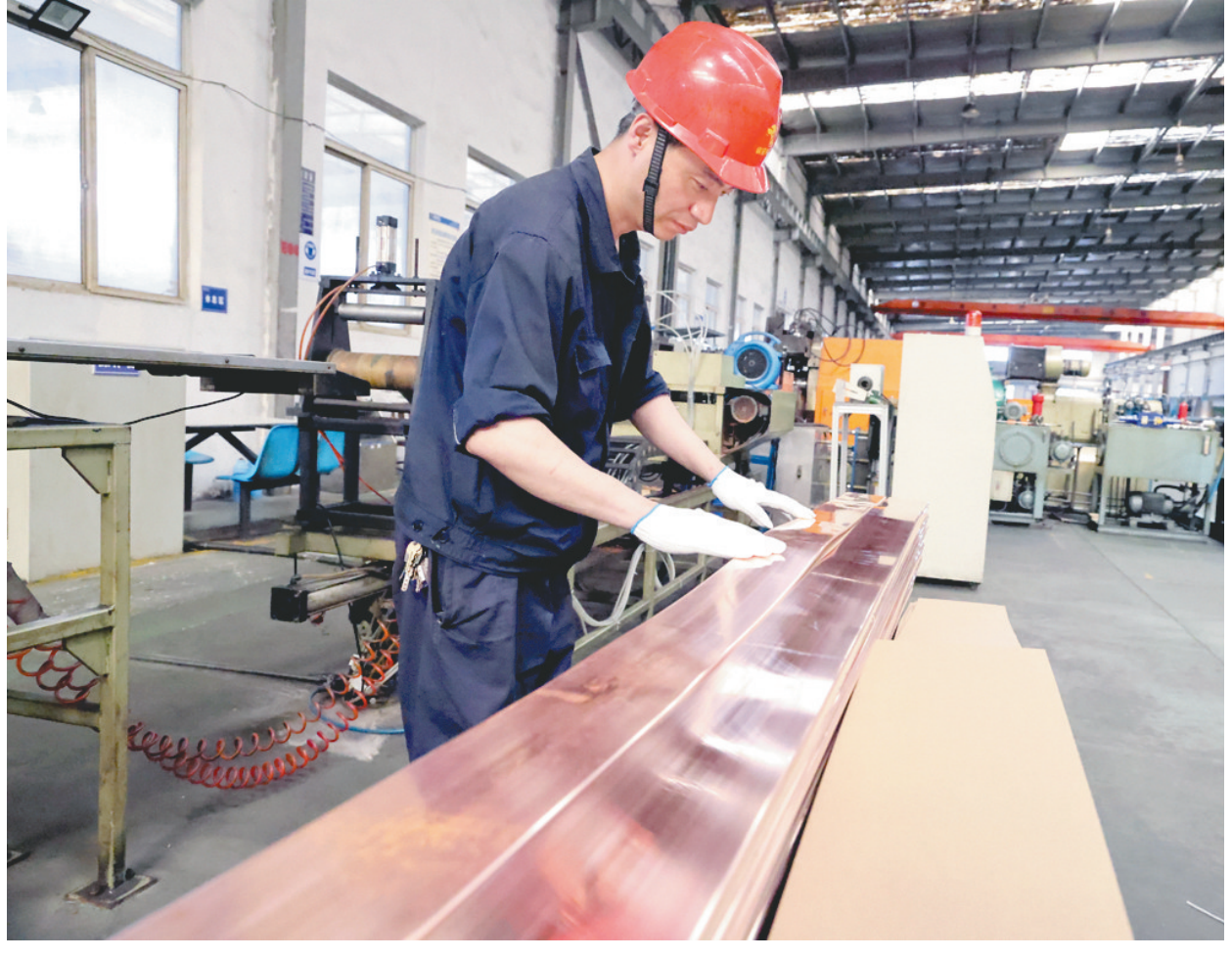
铜冠电工公司线材公司员工日前正在生产铜排。线材公司围绕磷铜和无氧铜两大系列生产线,瞄准新能源行业,积极研发适销新产品,其中,成功地研发了采用无氧铜杆挤压出的铜排产品,主要应用于新能源汽车上,目前该产品已实现量产。 本报记者 王红平 通讯员 岳 莹 摄
