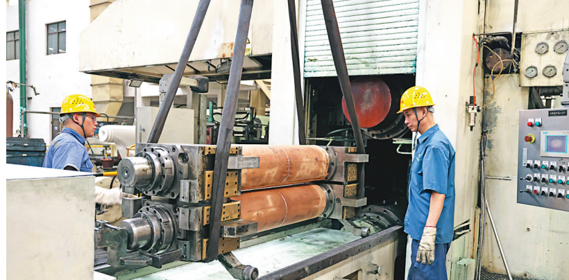
金威铜业分公司板带分厂员工日前正在换辊作业。金威铜业分公司板带分厂在强化生产过程控制,严把产品质量管理中,对轧辊定期更换保养,较好地保障了板带轧制质量。 本报记者 王红平 通讯员 方雷 摄
