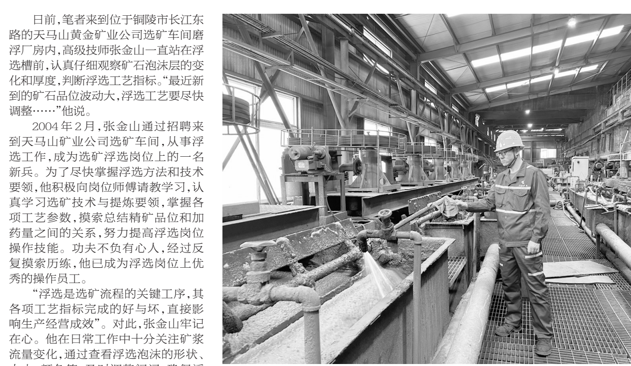
图为张金山在调节冲次水消除浮选槽中泡沫。
