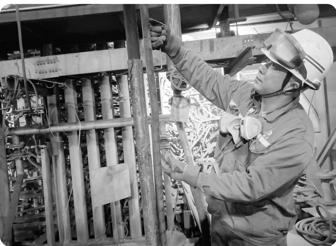
图为钱信华在测量闪速炉沉淀池内的冰铜与铜炉渣的液面高度。
