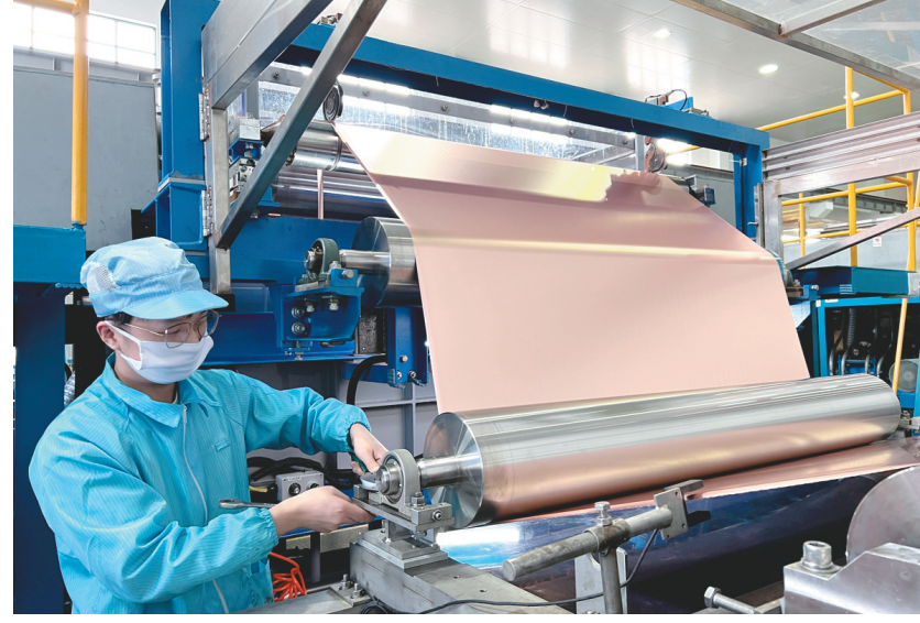
近日,铜陵铜箔公司进一步加强生箔设备管理工作,安排钳工进行每日开机检查,强化对设备的维护保养,保持设备高效运行,杜绝事故发生,保障生产连续稳定。图为该公司员工对生箔机进行检查。 本报记者 陈幸欣 通讯员 刘汤青 摄
