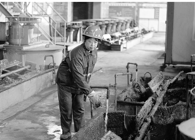
图为程丁红在浮选机旁认真关注水调试浮选液浓度。
