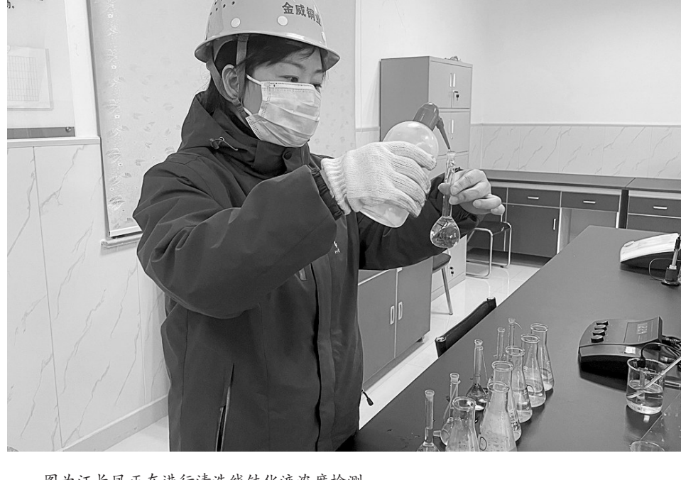
图为汪长凤正在进行清洗线钝化液浓度检测。
