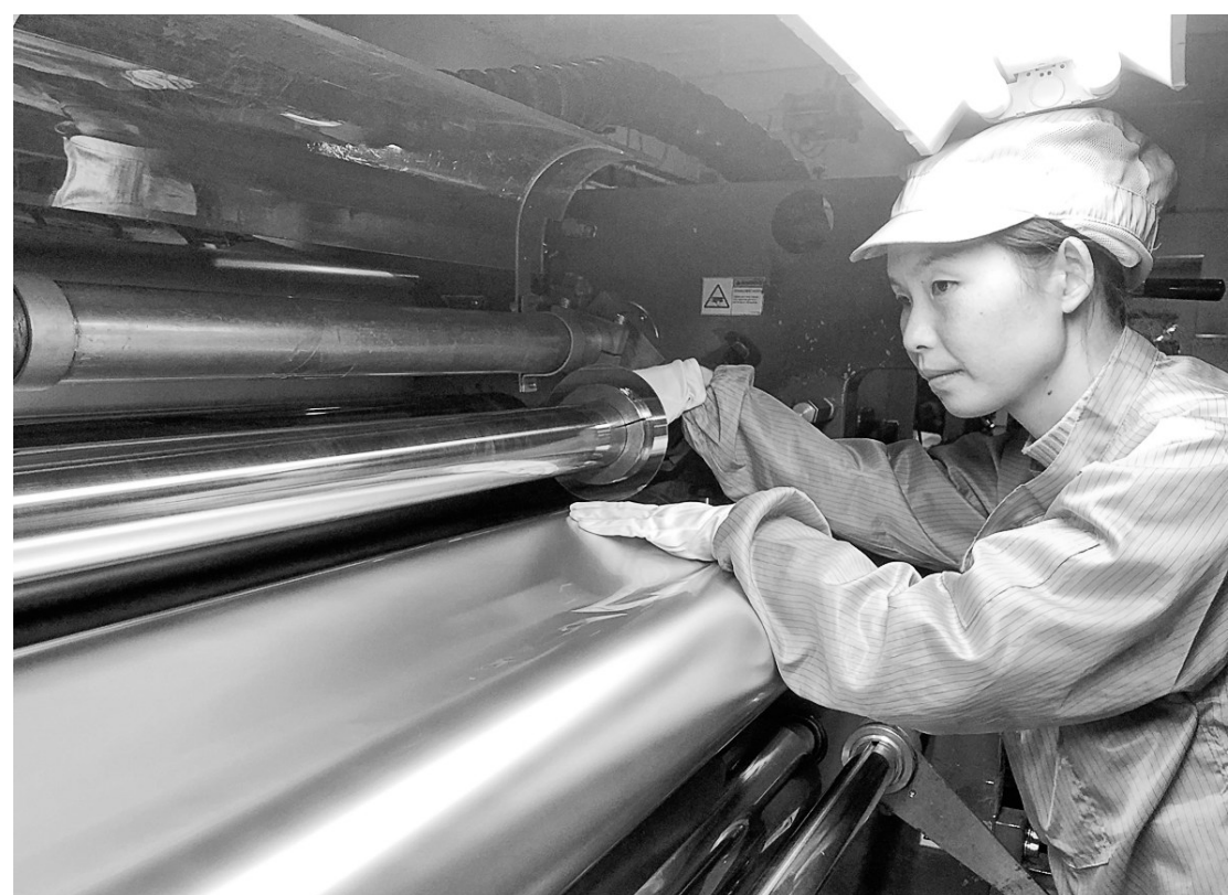
图为王丽正在调试分切机刀具,确保为HVL铜箔生产提供更优质的设备保障。
