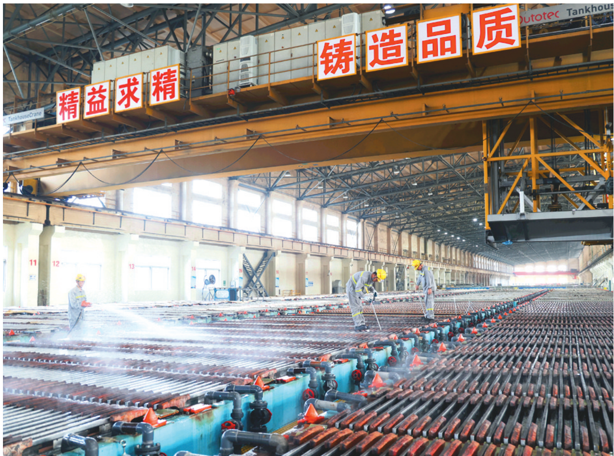
日前, 金冠铜业分公司双闪电解车间员工在电解槽面上进行出装槽作业。据悉, 该公司超额完成2023年产量及利润计划任务, 目前在抓好岁末年初安全稳定生产的同时, 积极统筹落实新一年各项工作安排。 吴家富 摄
