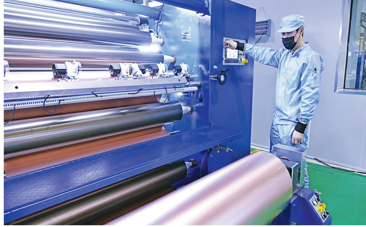
铜陵铜箔公司员工日前正分切作业。铜陵铜箔公司为克服铜箔产品加工费明显下降的不利影响，全力加大成本控制，进一步强化内外对标管理，不断挖潜降耗，加强能源管理，提高生产过程自动化，不断提升公司竞争力。王红平 刘洋 摄
