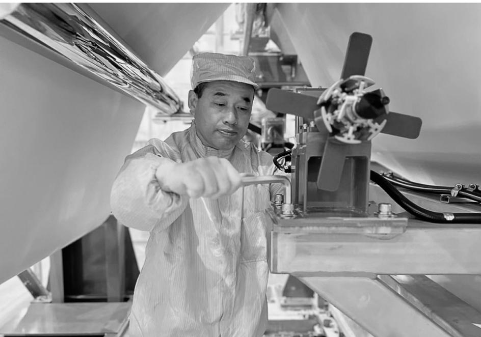
图为黄立功正在维修生箔机的铜箔边角器。
