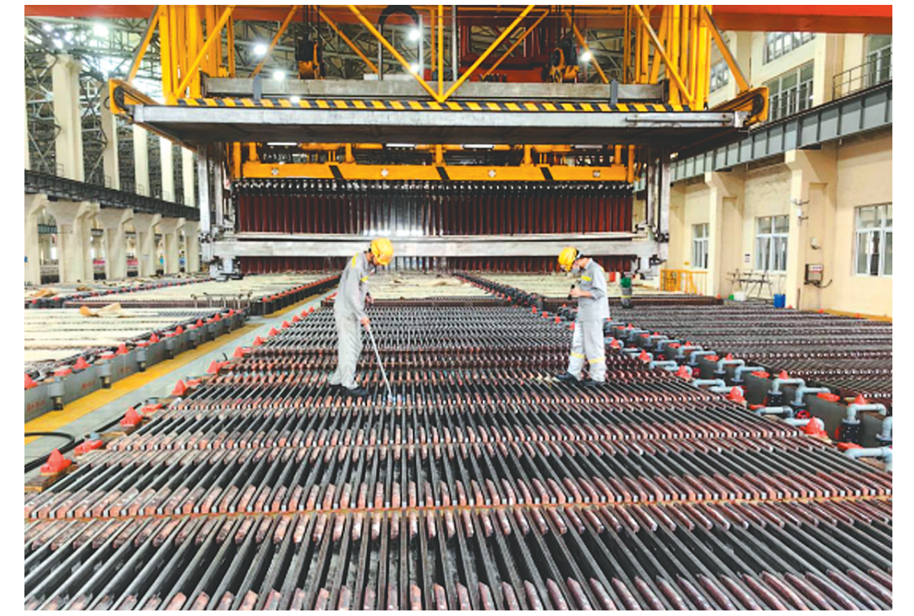
1至9月份,金冠铜业分公司奥炉电解车间阴极铜产量超计划3.66%,达年计划的80%,阴极铜质量持续保持高水准,高纯阴极铜比例达99.85%。据了解,该车间在保证主产品产量质量的前提下,积极探索推进高电流密度条件下生产节能降耗措施,9月份每吨铜综合电耗较7月份降低5.54千瓦时,效益明显。图为该车间员工日前正在电解槽面进行煎钎作业。杨雄伟 摄
