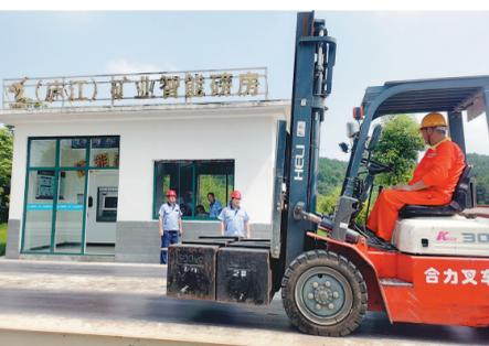
日前,铜冠(庐江)矿业公司技术人员正在对地磅进行校准。为保证人工磅房和智能磅房协同使用,稳定运行,该组织专业技术人员,利用供应链智能物流管控一体化技术,定期对地磅进行校准,保障计量数据真实准确。 尹若量 摄
