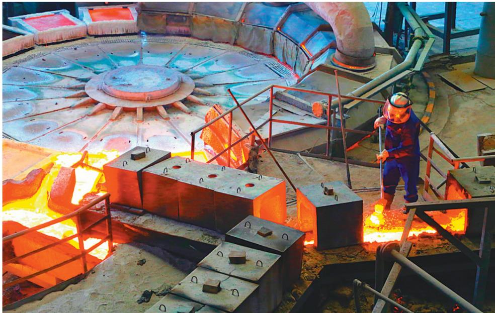
金隆铜业公司职工日前正在对热浪升腾的出铜流槽进行维护修理。1200摄氏度的铜水从阳极炉注入流槽,流槽的侧后方紧邻浇铸圆盘,这一区域属于超高温中心点,在这里工作,前熏后烤,环境十分艰苦,但金隆铜业公司职工不惧高温,哪里有生产需要就出现在哪里,在战高温、斗酷暑的季节里体现出了产业工人的责任与担当。
