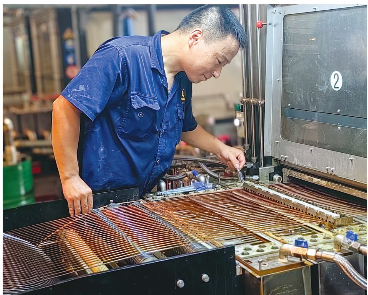
铜冠电工公司坚持提质、提产、降本、增效总体要求,全力稳产增产,强化降本增效,盘活销售龙头,细化开源节流举措,对生产设备设施存在的问题,坚持以自主维修为主降低成本。图为近日该公司维修人员正在对高速漆包机排线系统进行修复。 华伟摄
