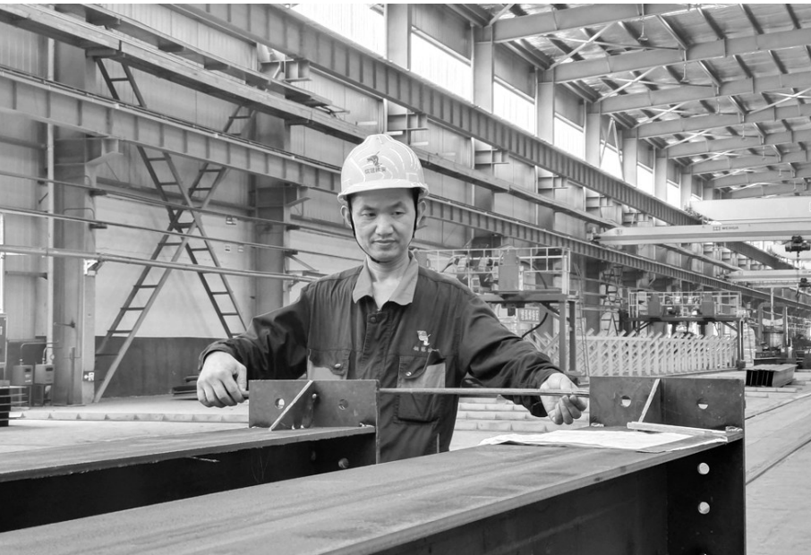
图为宣柱久正在复核出口国外钢构件产品尺寸。
