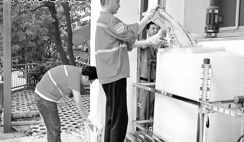
日前，矿产资源中心加强安全环保管理，认真开展安全风险管控和隐患排查治理。针对存在的隐患与薄弱环节，建立整改清单，明确整改责任、措施、时限，切实做到隐患见底、措施到底、整治彻底。图为该中心实验室人员为尾气处理溶碱桶加片碱。
