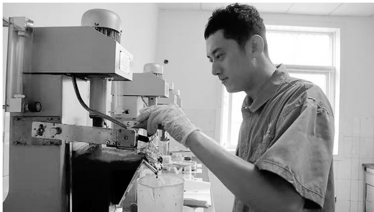
图为张弛正在选矿试验室进行浮选试验。
