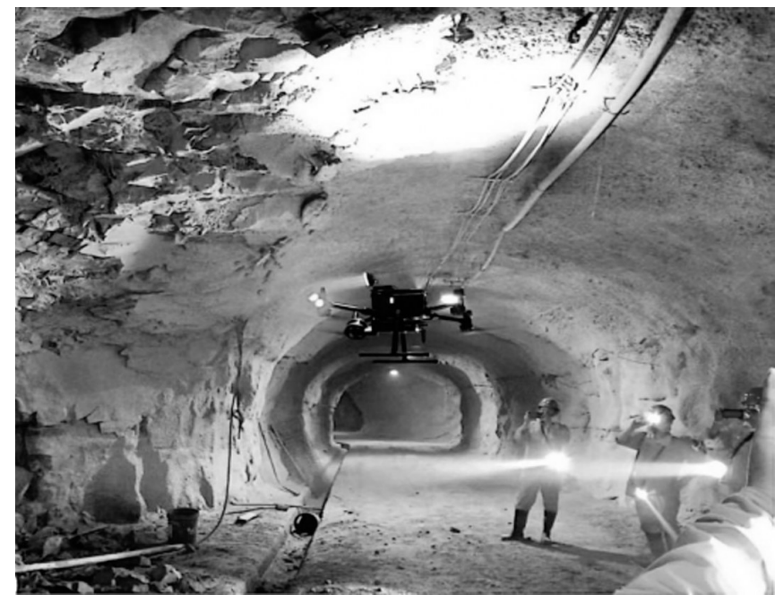
图为该公司有关人员在负705中段F107采场首次创新使用无人机进行采场空区探测。
