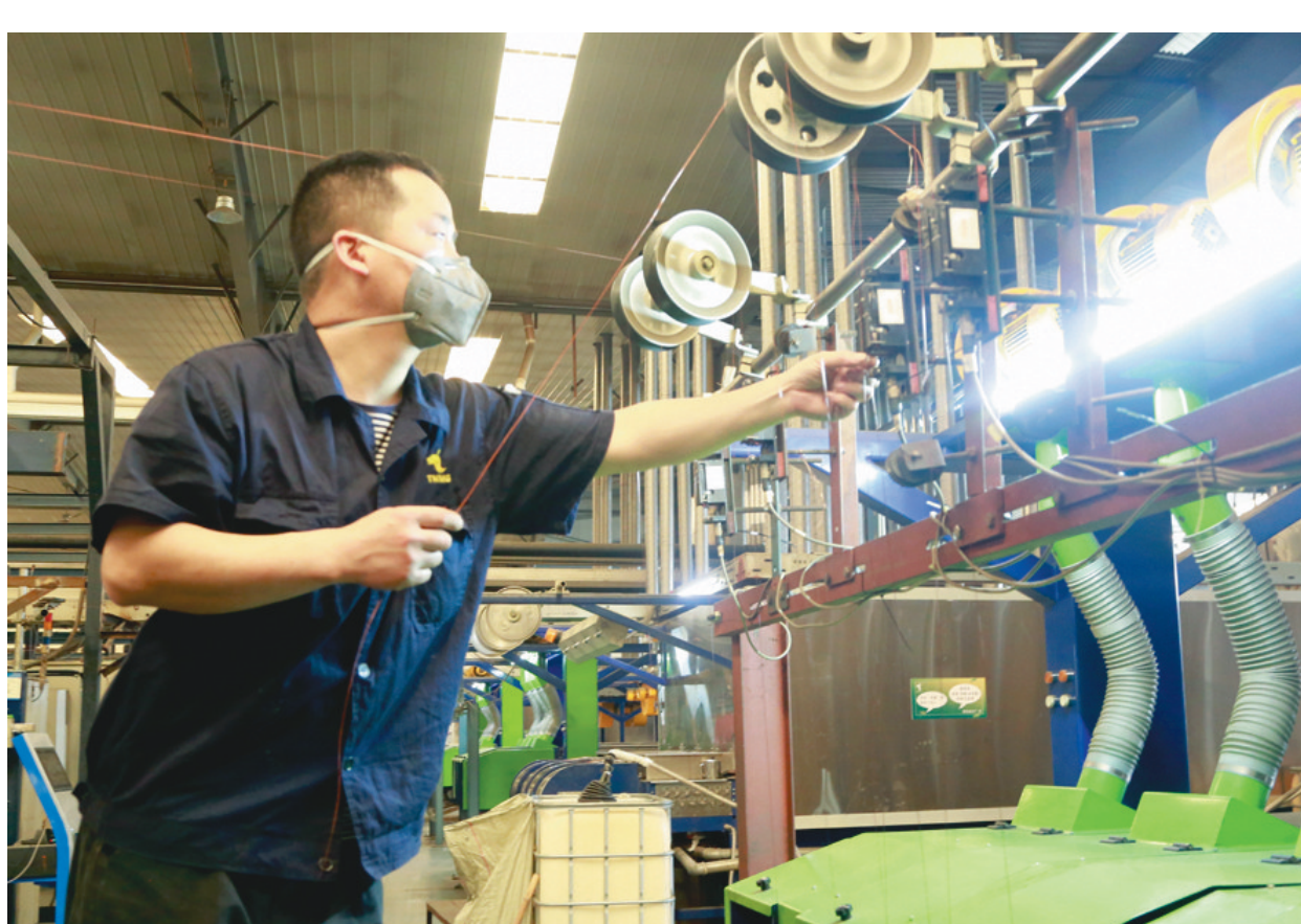
铜冠电工公司员工日前正在生产漆包线中穿线作业。该公司在贯彻落实对标世界一流企业价值创造行动中，积极引导一线员工立足岗位钻研技术，不断提升操作能力，努力生产一流的产品。
